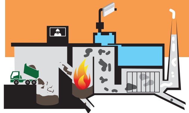
Schéma usine de traitement (valorisation énergétique des déchets par incinération)
