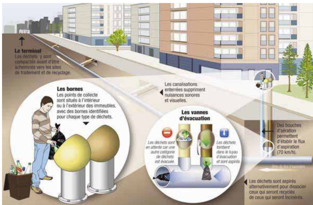
Schéma du process de la collecte pneumatique
