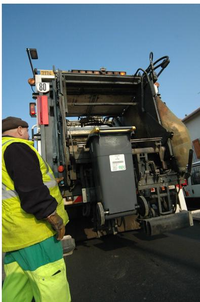
*Collecte par benne tasseuse des bacs multimatériaux
